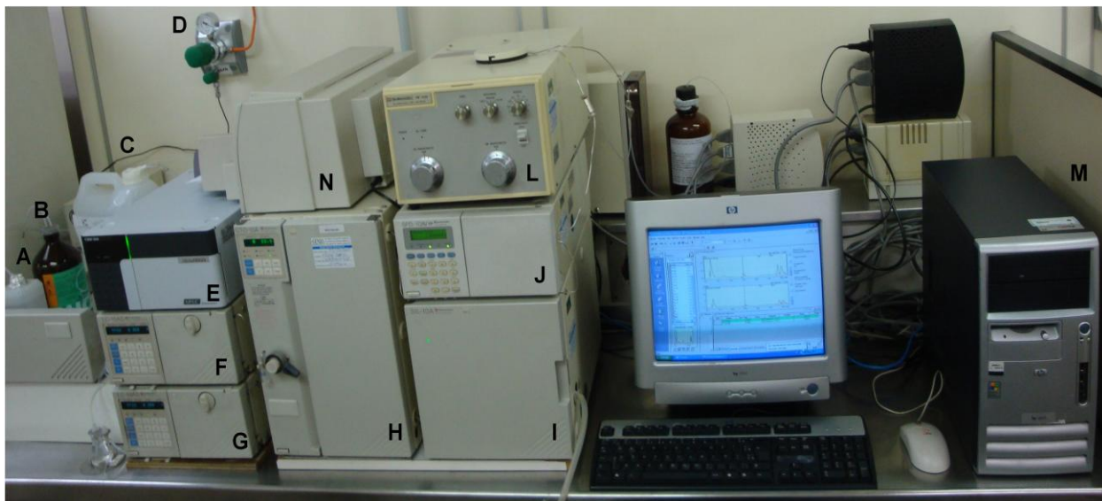
Figura 9. Equipamento HPLC modular utilizado nos experimentos, composto dos seguintes itens: reservatório da fase móvel A (A), reservatório da fase móvel B (B), coletor de resíduos (C), registro do gás hélio do degaseificador (D), controlador (E), bomba da fase móvel A (F), bomba da fase móvel B (G), forno onde está localizada a coluna (H), injetor automático (I), detector UV-Vis (J), detector de fluorescência (L), computador com software operacional (M), impressora para os cromatogramas (N).
