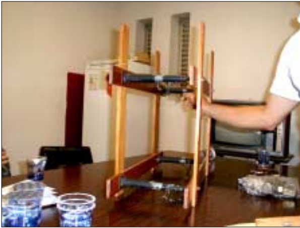
Fig. 19 – Maquete de dispositivo para escoramento de valas desenvolvido por técnicos de empresa de saneamento
