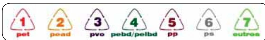
Figura 115 — Símbolos para identificação do tipo de plástico
