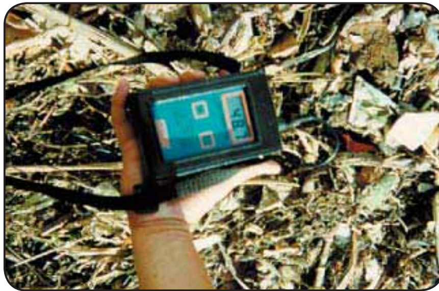
Foto 26 — medição de temperatura da leira
