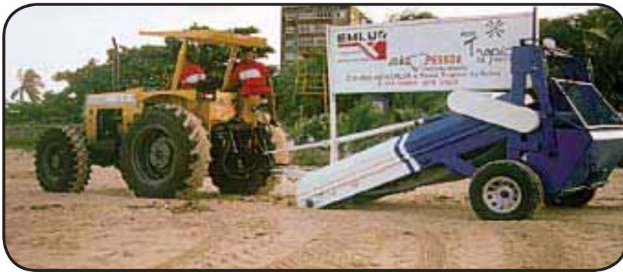
Foto 17 — Equipamento de limpeza de praia
