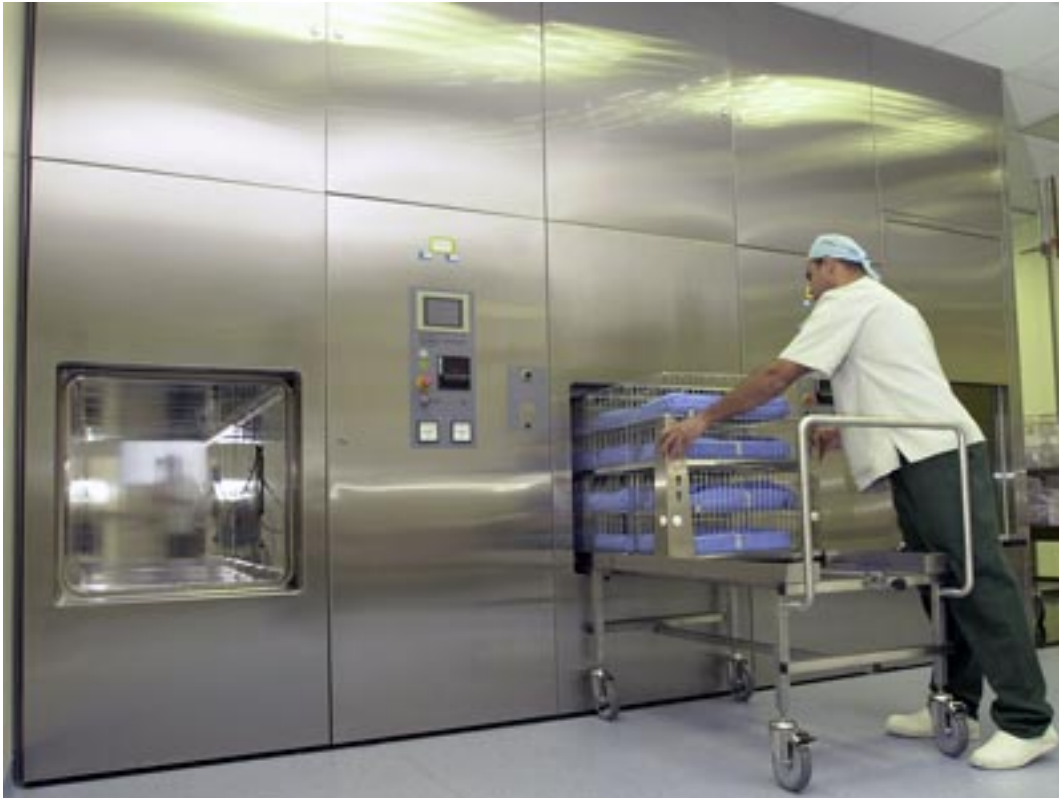
Figura 22– Autoclave de Barreira Fonte: H. Sírio-libanes
