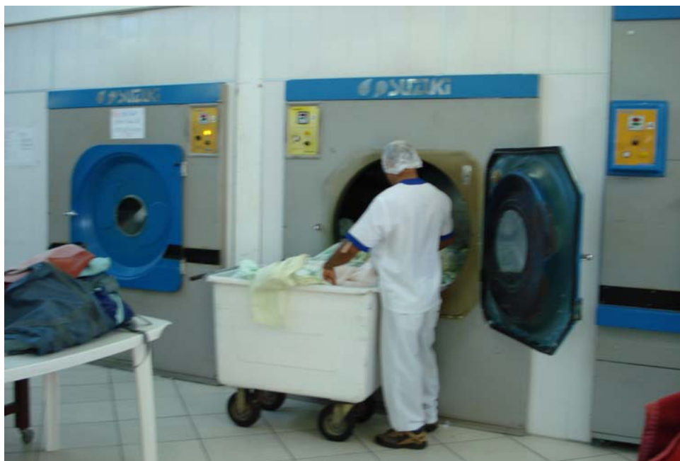
FIGURA 15 – Máquina de lavar de barreira separando área contaminada da limpa Fonte: A autora
