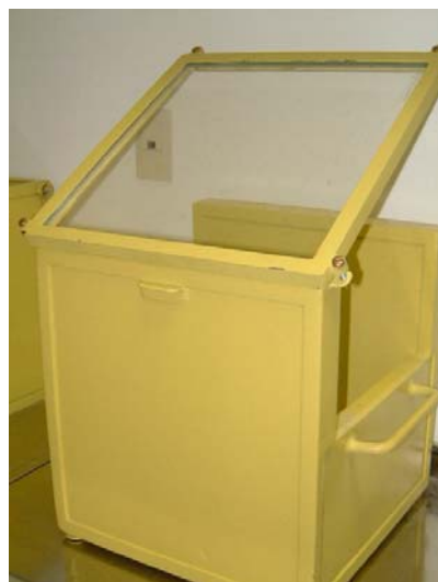
Fonte: COIRO, 2005. Figura 11: Visor plumbífero
