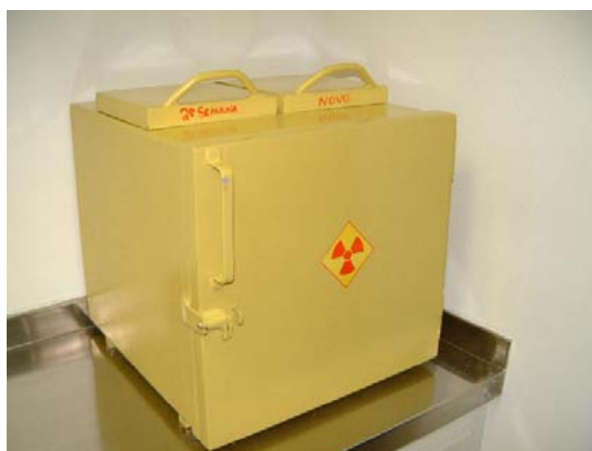
Fonte: COIRO, 2005. Figura 12: Caixa de chumbo
