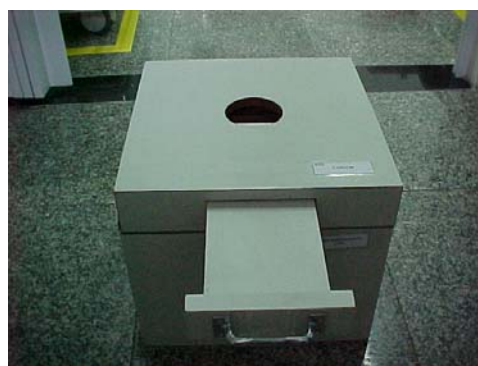
Fonte: COIRO, 2005. Figura 15: Caixa blindada para rejeitos
