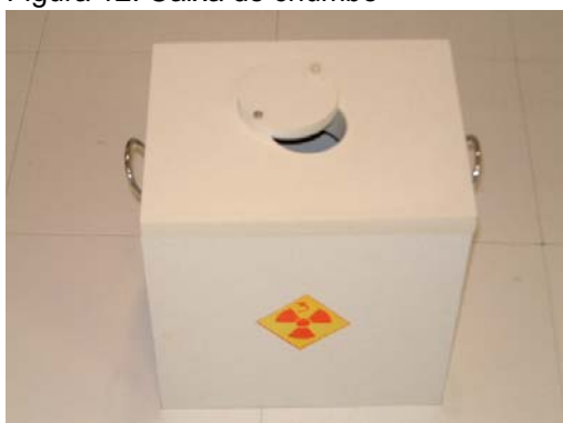
Fonte: COIRO, 2005. Figura 14: Caixa blindada para rejeitos
