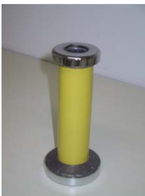
Fonte: COIRO, 2005. Figura 16: Blindagem para seringa
