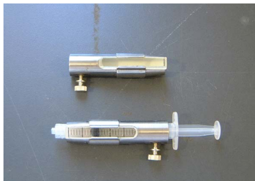
Fonte: COIRO, 2005. Figura 17: Transportador de seringa
