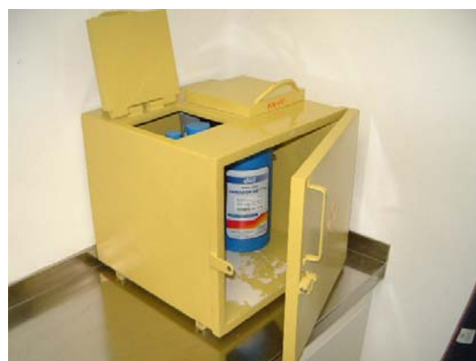
Fonte: COIRO, 2005. Figura 13: Caixa de chumbo
