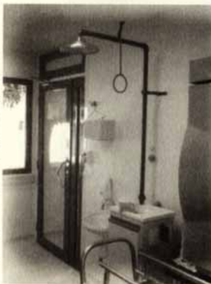
Figura 2 – Porta de acesso laboratório com nível de biossegurança II, com chuveiro e lavatório
