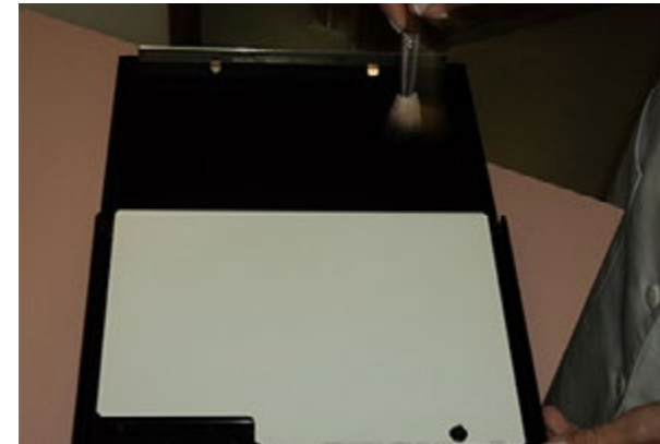
Figura 35. Técnica realizando limpeza nos chassis Fonte: Acervo SQRI.
