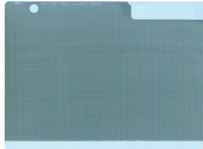
Figura 93. Radiografia da malha metálica usada no teste de contato tela-filme. O quadro no canto superior serve como orientação para identificar as regiões onde o contato é pobre Fonte: Acervo SQRI.
