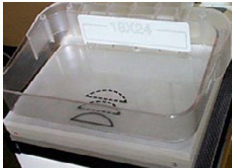
Figura 89. Placas de acrílico posicionadas para o teste de avaliação de artefatos na imagem Fonte: Dance [20--?].
