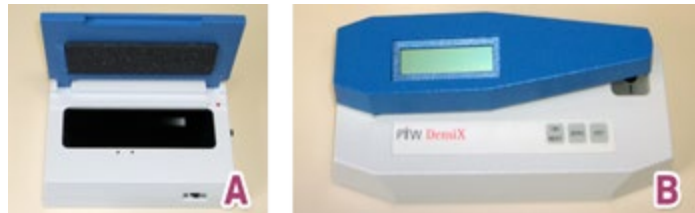
Figura 85. Instrumentos para sensitometria. Em A, sensitômetro; em B, densitômetro Fonte: Acervo SQRI.
