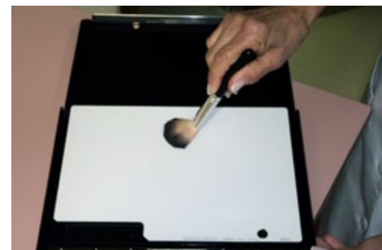
Figura 82. Limpeza de chassi com pincel Fonte: Acervo SQRI.
