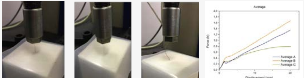
Figura 9 – Ensaio mecânico das agulhas (esquerda) e respectivos resultados (direita)
