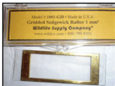
Figura 24 – Câmara de Sedgwick Rafter
