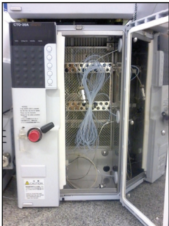
Figura 49 – Detalhe do forno do sistema de HPLC mostrando o tubo de teflon enrolado na forma de “8”
