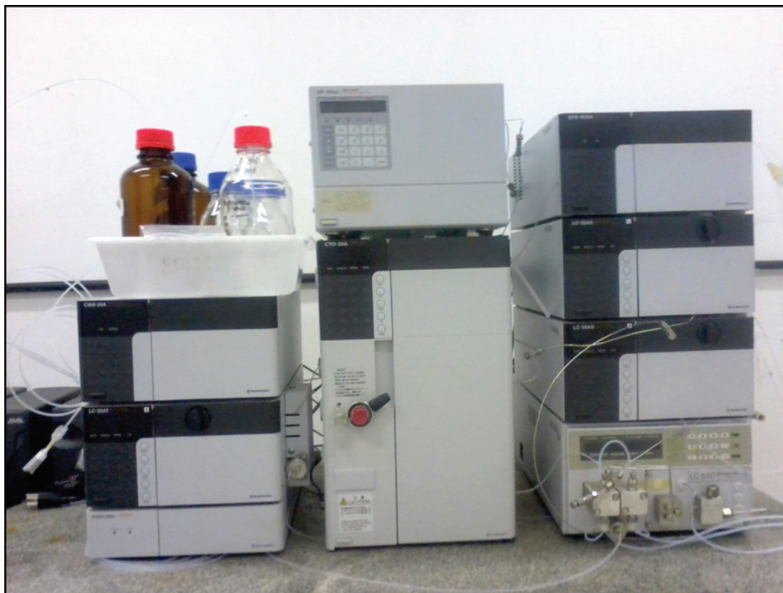
Figura 44 – Equipamento de cromatografia líquida de alta eficiência composto por três bombas, sendo uma em sistema quaternário para realização de gradiente, degaseificador, detector de fluorescência, forno, detector de UV-Vis com arranjo de diodo e unidade de controle, que faz a conexão de todos os módulos com o microcomputador
