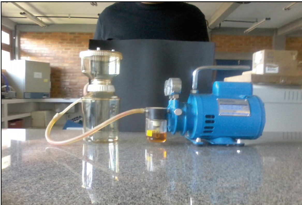
Figura 11 – Suporte de filtração para membranas de 47 mm de diâmetro conectado a uma bomba de vácuo
