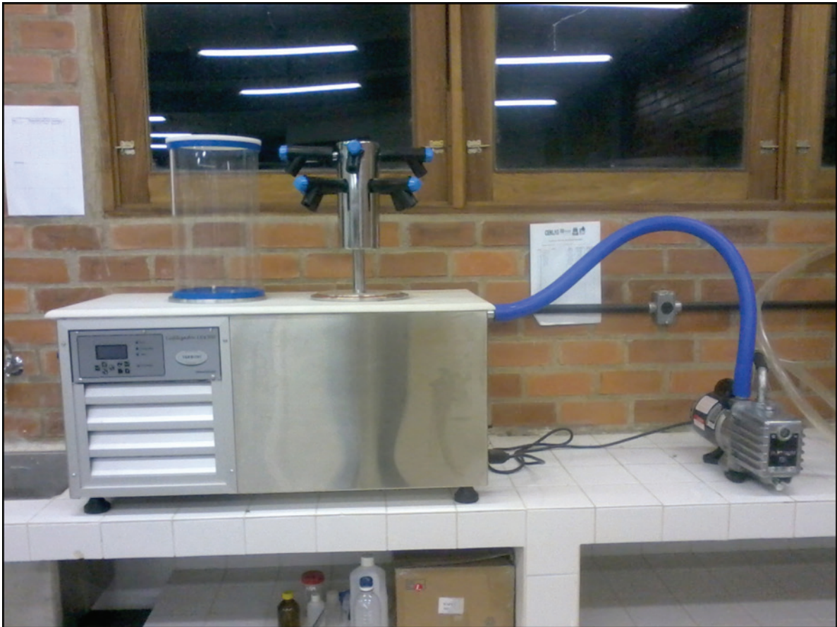
Figura 12 – Sistema de liofilização composto por torre e câmara de liofilização acoplados à bomba de alto vácuo
