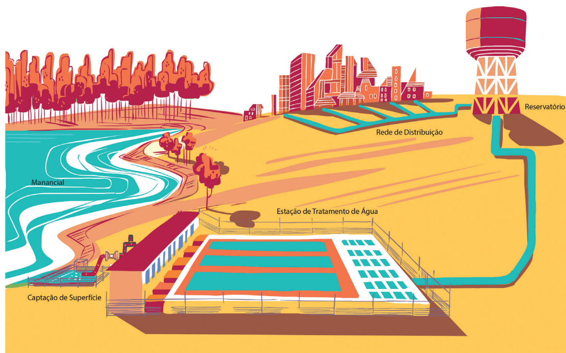
Figura 2 – Figura esquemática de Sistema de Abastecimento de Água
