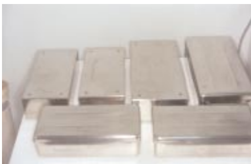
Fig 3. Caixas metálicas fechadas para esterilização em forno de Pasteur ou estufa para esterilização
