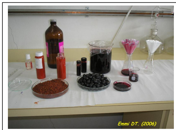
Figura 2 – Material utilizado para confecção dos evidenciadores com corantes de açaí (antocianinas) e urucum (bixina e norbixina).
