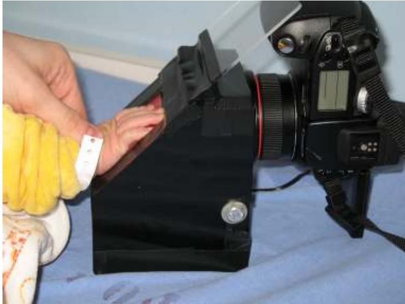
Figura 5: Sensor óptico com área de captura de 35 \times 45mm e resolução aproximada de 1400dpi , utilizado para adquirir impressões plantares e palmares de recém-nascidos.
